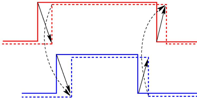
Nous obtenons le schéma de transition ci-dessous pour la synchronisation faible de réactions fortes.
