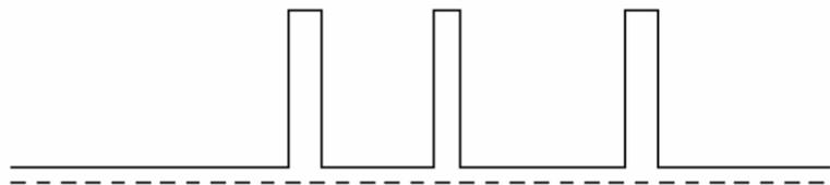
Tous ces cas vont être traités par un même modèle où nous avons une synchronisation faible entre l'action et la réaction. Un compteur appelé  $ca$  est associé à  $a$ , et un compteur  $cr$  est associé à  $r$ . Ces compteurs indiquent le nombre de fois où action et réaction sont passés à l'état haut (le nombre de fronts montants).
